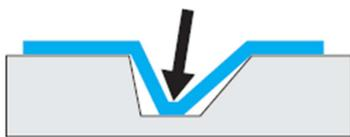
Déformer l'adhésif avec le doigt afin de lui faire prendre la forme de la surface concave. (utiliser toujours des gants propres)
